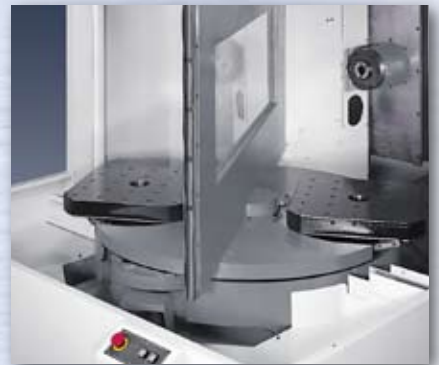
● 連動APC 防護門 (H500A/B)
